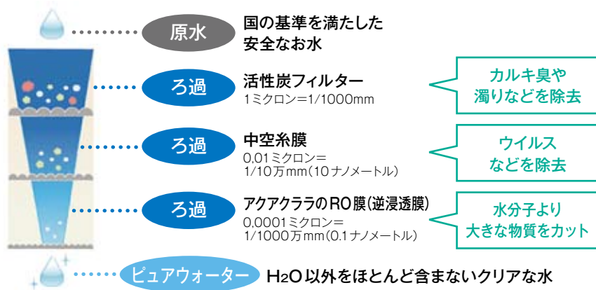
図1.RO膜を使ったろ過システム
