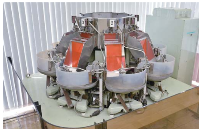
図1. 世界初のコンピュータスケール(2017年度機械遺産第89号に登録)
